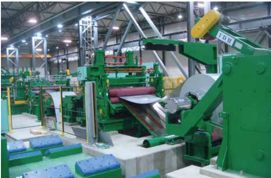
Hitachi Querteilanlage: Kontinuierlicher Betrieb wird durch zwei Stapelnerster gewährleistet.
