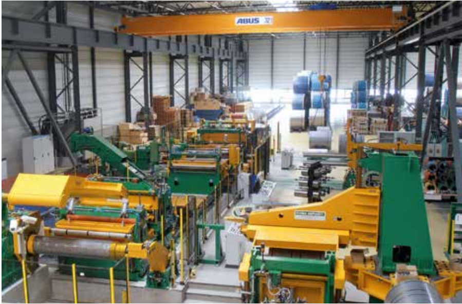
Guida Spaltanlage: Spalten bis zu 6 mm Dicke möglich.
